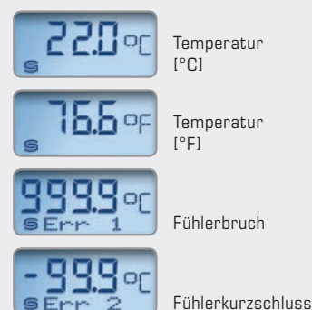
Anzeige und Eigendiagnostik THERMASGARD® Messumformer mit Display
