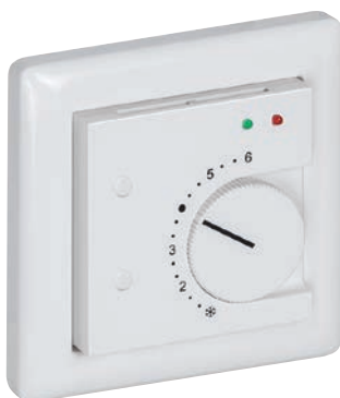
FSTF xx P2L2T Ausführung mit Fühler, Potentiometer (1 kOhm, max. 0,1 W), 2 Leuchtdioden (grün, rot) und 2 Tastern (max. 24 V DC, max. 10 mA)
