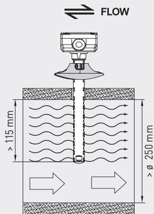
Sensor de la calidad del aire para canales (COV) y convertidor de medida, incl. brida de montaje, autocalibrable, con conmutación de varios rangos y salida activa/con capacidad de maniobra
